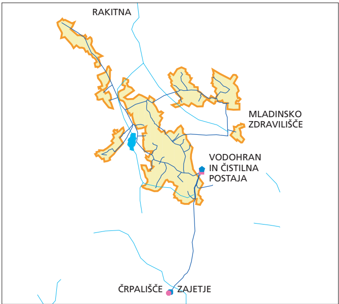
RAKITNA: 1 naselja Rakitna, Boršt, Jezero, Naklič, Novaki, Žotov grič, Stelnik 2 Brezovica 3 ca. 11000 m 4 filtracija na peščenih filtrih, ozoniranje, dezinfekcija s plinskim klorom 5 potok Podresnik oz. Žetovec 6 nelegalni priključki na sistem, potek javnega sistema oskrbe po lastniških parcelah 7 zamenjava skupinskih priključkov s posamičnimi, izgradnja novega sistema izven lastniških parcel, izgradnja prečrpalnice za zaselek Boršt (slike z leve proti desni; slika 1) Zajetje s črpališčem v dolini potoka Podresnik za vodovod Rakitna (slika 2) Objekt za pripravo vode na Rakitni (slika 3) Naprava za pripravo vode (slika 4) Vodohran na Rakitni
