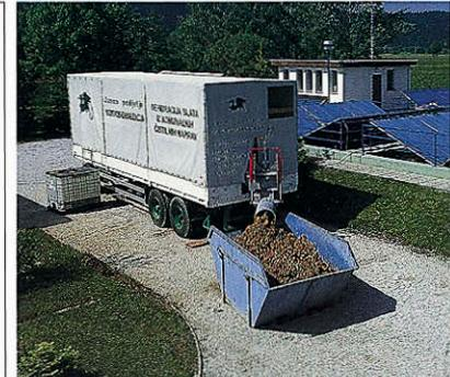
Dehidracija blata na čistilni napravi Matena
