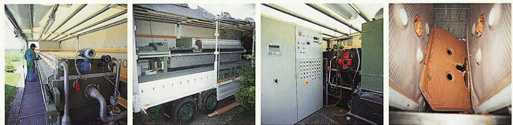
Detalji mobilne filtrske stiskalnice, ki je na področju dehidracije blata iz komunalnih čistilnih naprav v samem vrhu moderne tehnologije. Na prvi sliki z desne je prikazan končni produkt po postopku dehidracije – pogača blata, osušena do 40 odstotkov suhe snovi.
