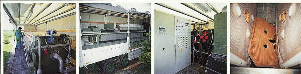
Detajli mobilne filterske stiskalnice, ki je na področju dehidracije blata iz komunalnih čistilnih naprav v samem vrhu moderne tehnologije. Na prvi sliki z desne je prikazan končni produkt po postopku dehidracije – pogača blata, osušena do 40 odstotkov suhe snovi.
