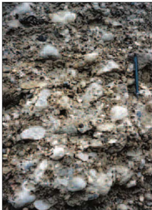
Slika 40: Konglomerat v gradbeni jami avtocestne obvoznice v Polju.
