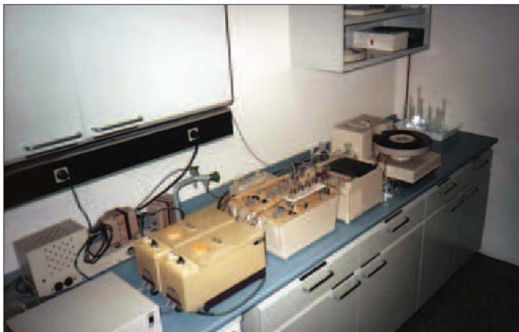
Slika 109: Aparat za določanje vsebnosti rastlinam lahko dostopnih oblik dušika (nitrata, amonij in nitrit) v tleh.
