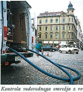
Kontrola vodovodnega omrežja z vozilom za iskanje okvar.
