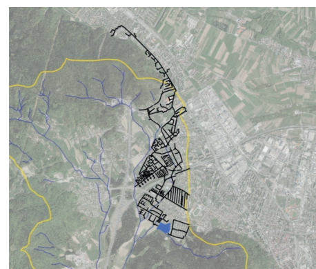
Slika 15: Odvodni sistem padavinske odvodnje, postavljen v programu Qgis za potrebe modeliranja v SWMM
