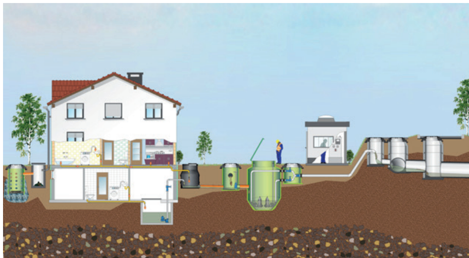
Slika 1: Shematski prikaz hišnega črpališča in črpališča na kanalizacijskem sistemu.
